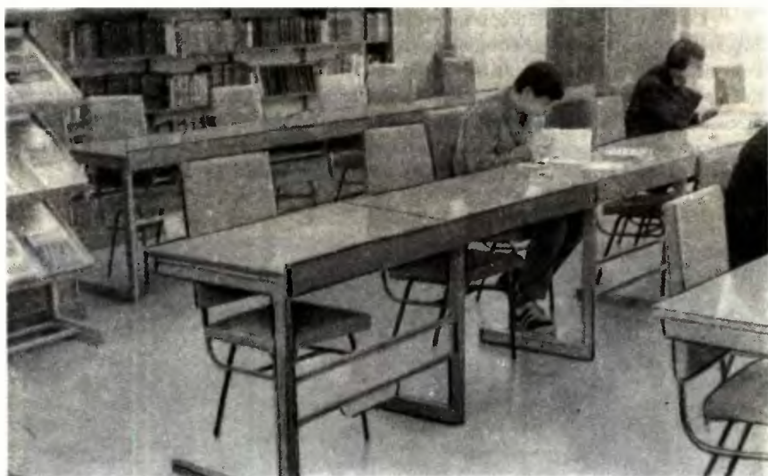
Fot. 30. Zaprojektowane przez M. Gargalę czteroosobowe stoły jednostronne. Oryginalna konstrukcja „nóg” stolów (wykonana z płaskorurowych przekrojów duraluminiowych) zapewnia wygodne zajmowanie miejsc przy stole (Biblioteka Publiczna m. st. Warszawy — Czytelnia Czasopism).
