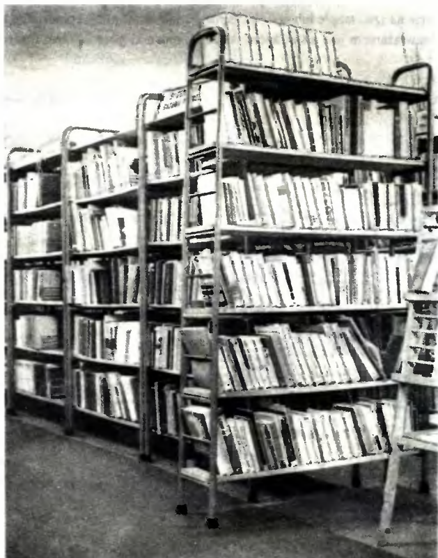
Fot. 16. Krajowy regał drabinkowy, metalowy, półki drewniane. Mimo drabinkowej konstrukcji zmiana odstępu półek w tych regałach jest praktycznie niemożliwa, wymaga demontażu segmentów, przy tym skok regulacji jest zbyt duży (15 cm).
