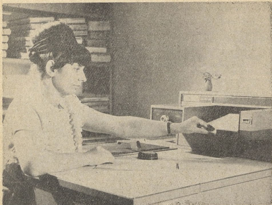
Do wykonywania kopii bezpośrednio z oryginałów służy aparat kserograficzny Rank-Xerox 914
