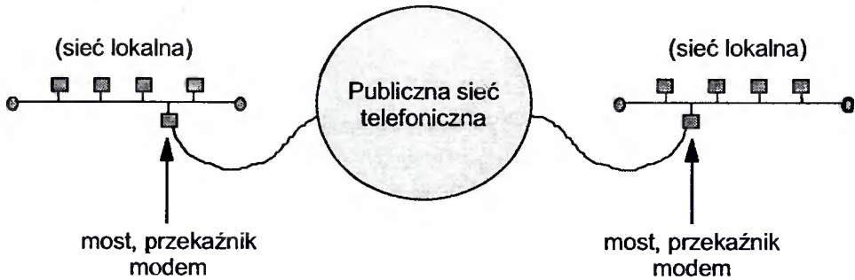
Rys. 2.5 Schemat rozległej sieci komputerowej 16
