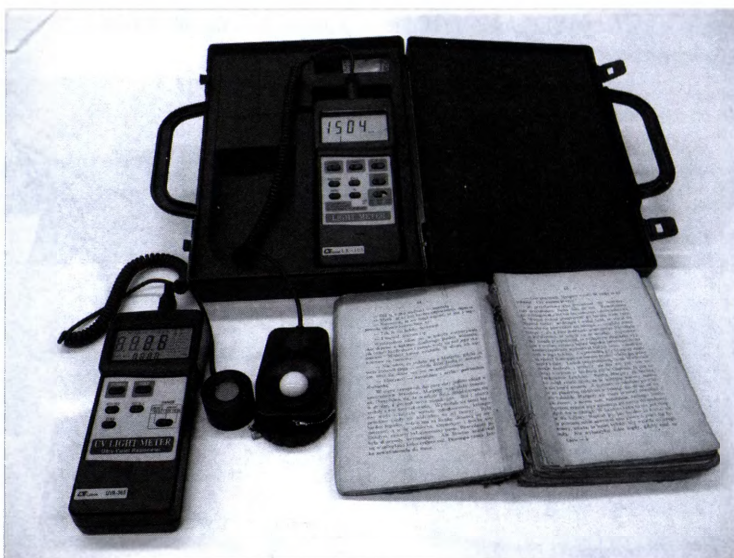
Pomiar natężenia światła i określenie zawartości promieniowania UV. LX-105 prod. Lutron, zakres 0-50000 luksów, wybór oświetlenia: dzienne, żarowe, jarzeniowe, rtęciowe oraz światłomierz UVA - 365 prod. Lutrom, zakresy: 1999,9 \mu\text{W}/\text{cm}^2 ; 1,99919,99 \text{ mW}/\text{cm}^2
