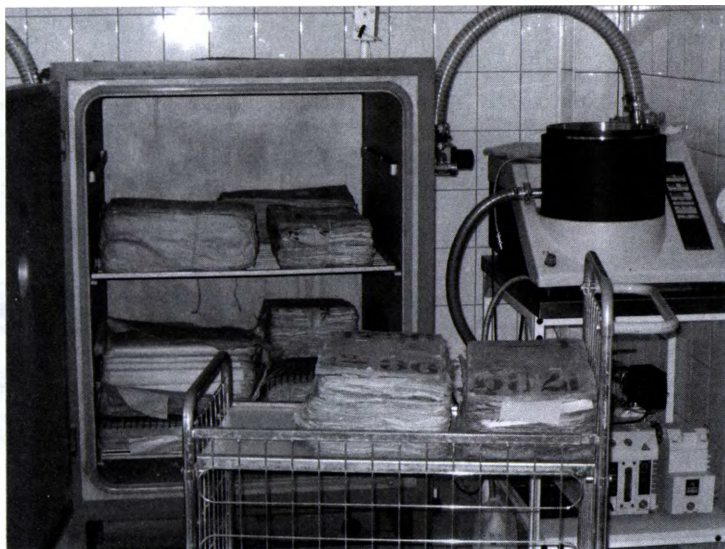
Suszenie sublimacyjne obiektów zalanych podczas powodzi i zamrożonych w liofilizatorze firmy AMSC/Fin Aqua, widok urządzenia podczas załadunku
