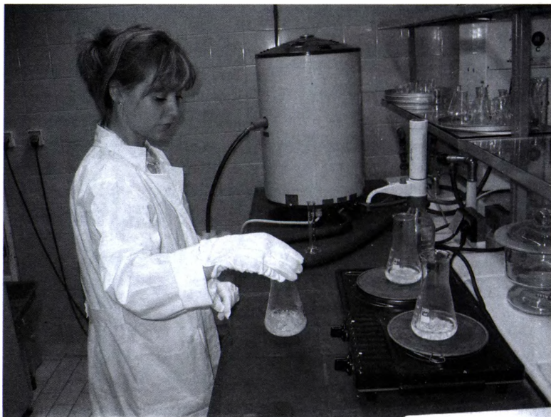
Przygotowanie próbek papieru do oznaczania rezerwy zasadowej wg ISO 10716
