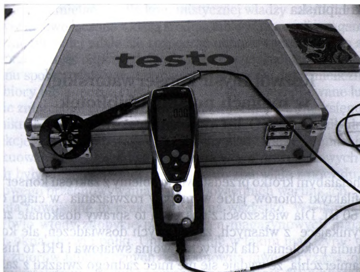
Miernik wielofunkcyjny z trzema sondami (pomiar: temperatury, wilgotności i prędkości przepływu powietrza), firma Testo, typ 435-2, prędkość przepływu od 0 do 60 m/s
