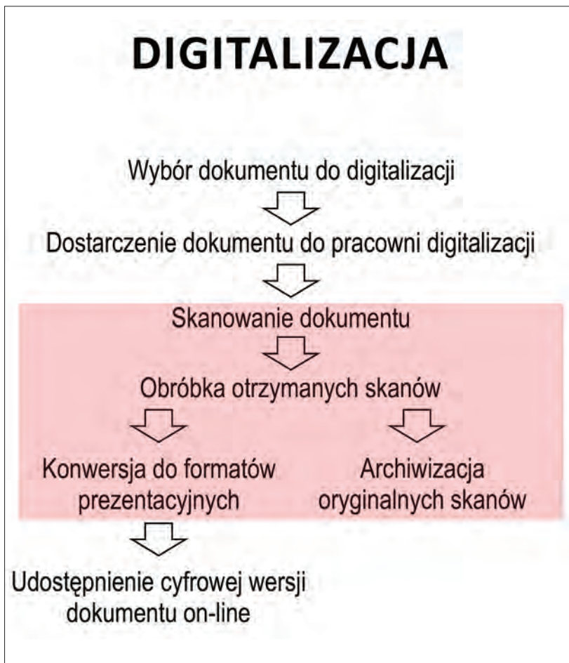
Rys. 1. Uproszczony schemat etapów digitalizacji w ujęciu szerokim. Na czerwono podświetlono etapy składające się na wąskie ujęcie digitalizacji.
