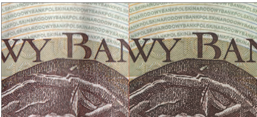
Rys. 11. Porównanie jakości wykonanych skanów: z lewej strony ze skanera A4 Canon LiDE 110, z prawej – skanera A3 Epson GT-15000.
