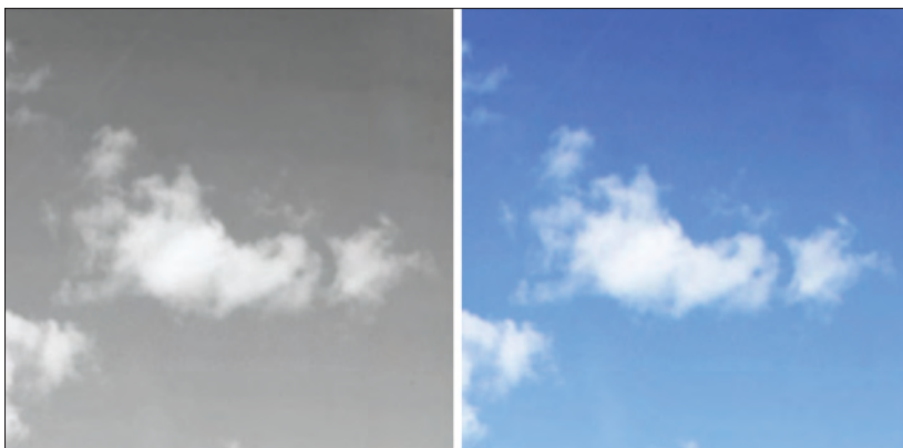
Rys. 9. Z lewej strony – 8-bitowe odcienie szarości, z prawej – 24-bitowy kolor.
