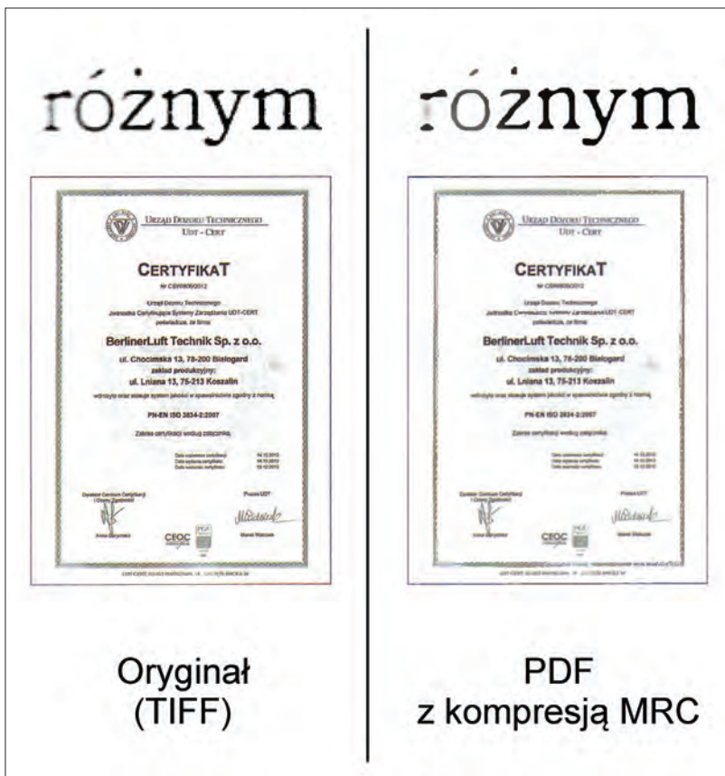
Rys. 166. Błędy powstałe w wyniku zastosowania kompresji MRC.
